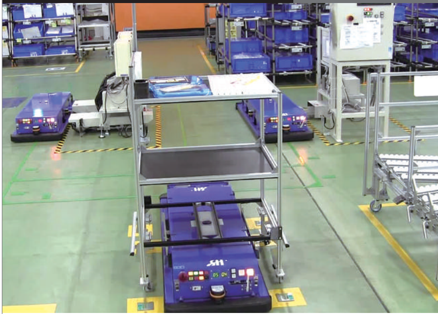
床を走る青色の機械がシンテックホズミの無人搬送車(AGV)。優れた制御技術によって生産物流の無人化・省力化を実現している。
